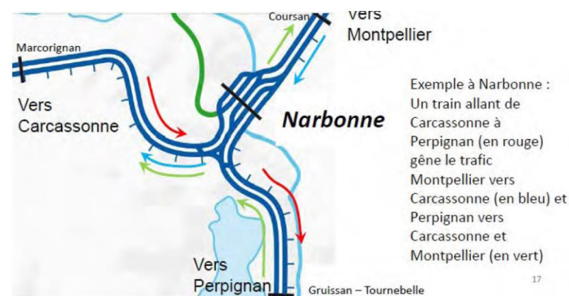
Figure 83 : Triangle de Narbonne, au Sud-Ouest de la gare (les trains roulent à gauche) (source : Observatoire de la saturation ferroviaire entre Nîmes et Perpignan, CGEDD, mai 2016)
