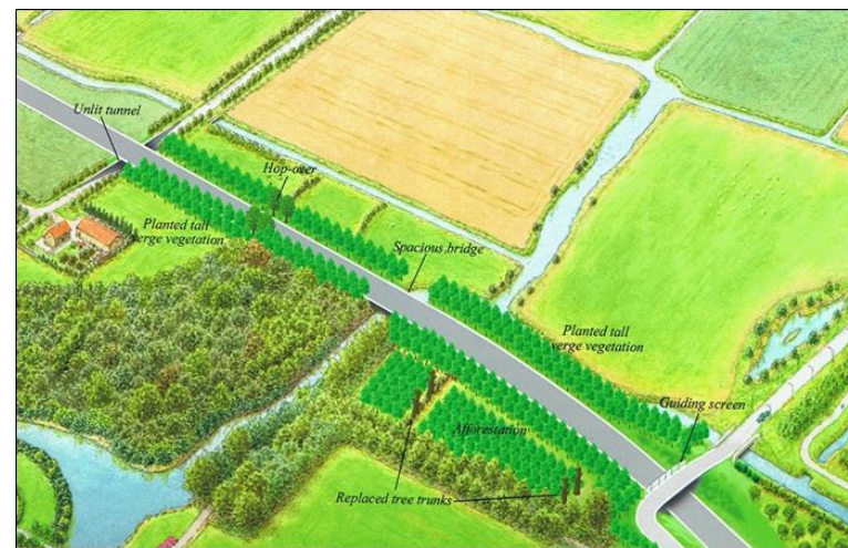
Figure 23 : Passage d'une chauve-souris par un Hop-over (image du haut) et exemples d'installations favorables aux chiroptères lors de la construction d'une route (source : LIMPENS et al., 2005)
